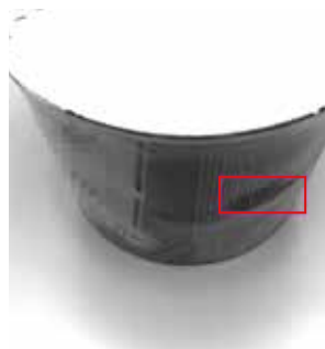
热缩膜桶面侧面破损
