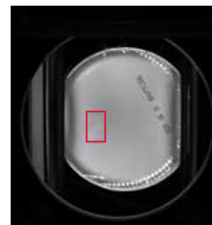
热缩膜桶面底部破损&amp;喷码日期检测
