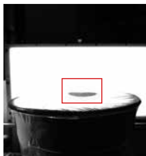
热缩膜桶面顶部破损成像
